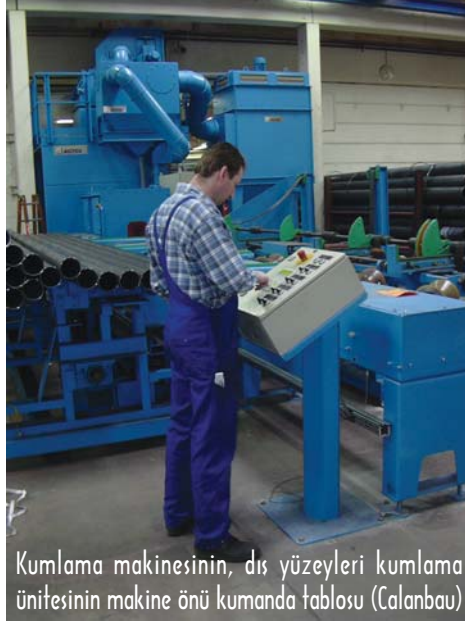
Dış yüzeylerin kumlanması için Diabolo-Rulo-Konveyör sistemi boruların güvenli dönmesini ve ileri sürülmesini sağlar. (Calanbau)
